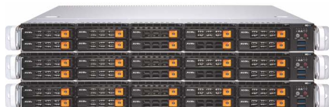
Proxmox Cluster, FullFlash Knoten mit je 10 2.5" NVMe U.2 Slots
