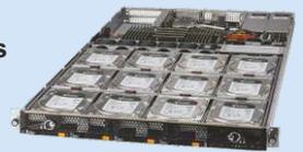
**Besonders hoher Datendurchsatz**, auch bei hoher Kapazität, wird bei diesen Clustern durch eine intelligente Kombination von HDDs und SSDs erzielt. Die NVMe SSDs speichern sowohl Metadaten als auch prädiktiven Lese-Cache. Die Daten werden dann in Containern zusammengefasst und
